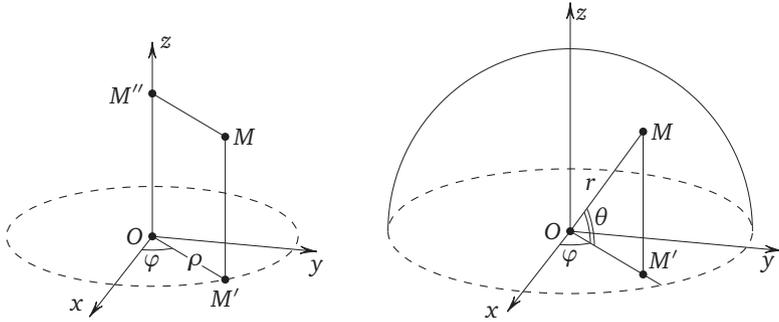
Рис. 4. Цилиндрические и сферические координаты
