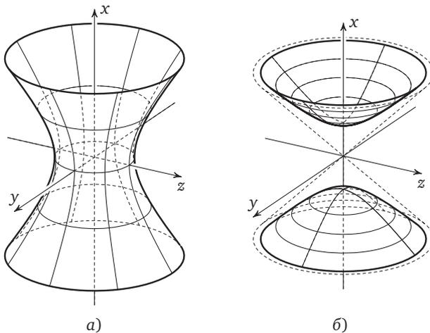
Рис. 34. Однополостный и двуполостный гиперболоиды
