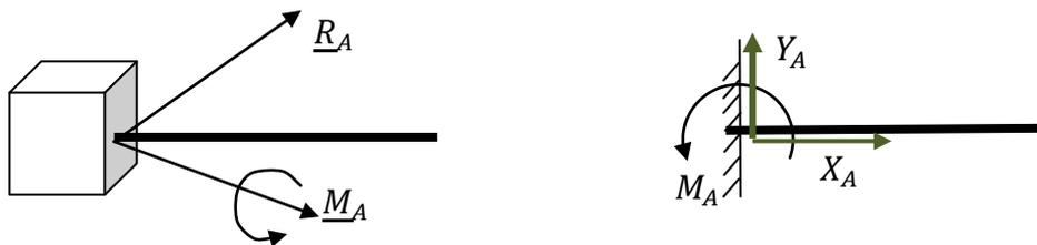
Заделка действует на тело (балку) неизвестной силой  $\underline{R}_A$ , препятствующей движению во всех направлениях и моментом  $\underline{M}_A$ , препятствующим повороту вокруг любой оси.
