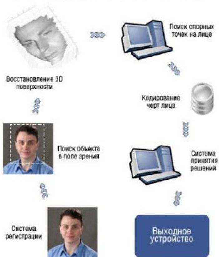
Рис.2.7. Принцип работы системы распознавания
